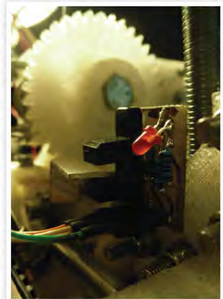
Figuur 6: Opto-endstop van de x-as
