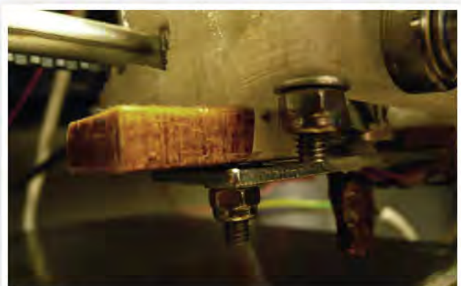
Figuur 8: De connectie tussen de hot end en het wagentje.
