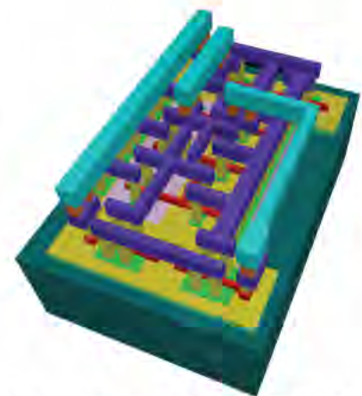
3D Layout van een simpel geheugencelletje van 3.5\mu\text{m} \times 2.5\mu\text{m}
