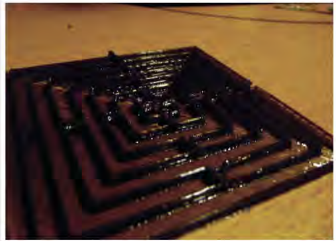
Figuur 12: Een backlash maze om te bepalen of er speling zit in de aandrijfbandjes.
