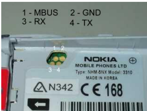
Figuur 2: Plaatsing en pinout van de FBUS op een Nokia 3310
